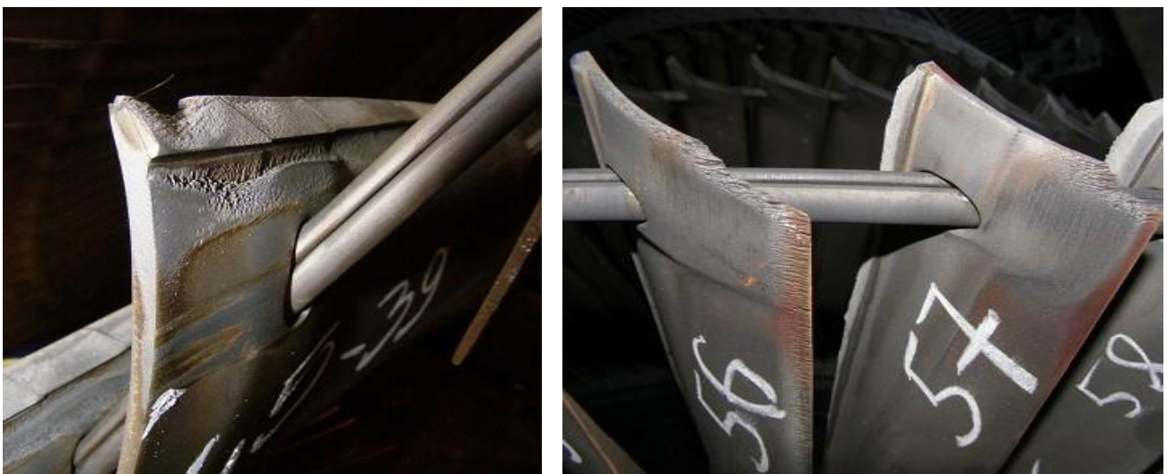
Slika 10. - Izgled oštećenih lopatica prije sanacije
