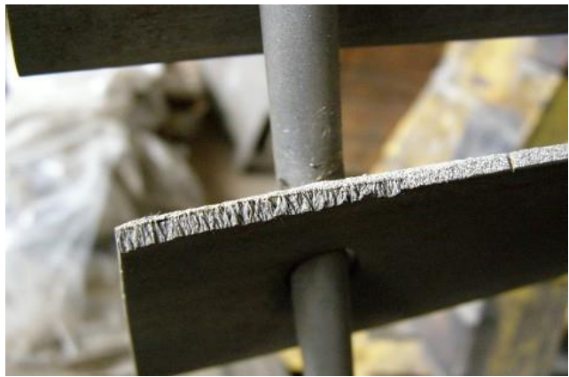
Slika 7.-Izgled oštećene lopatice na ulaznoj ivici
