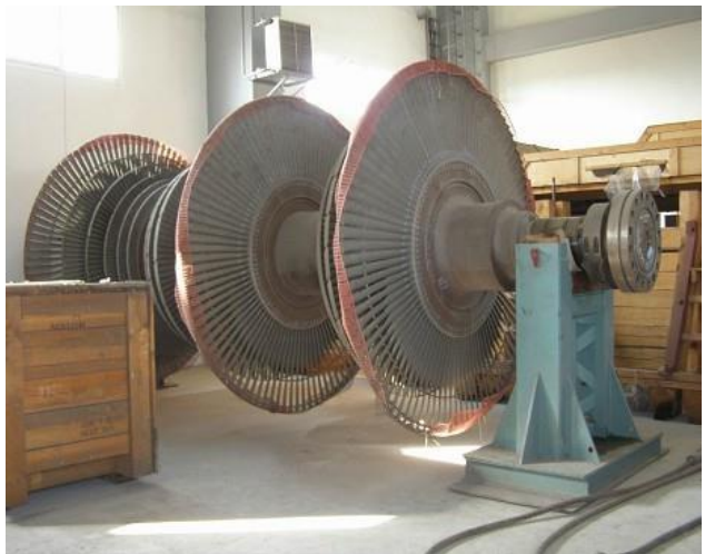
Slika 8. - Rotor Alstom 300 MW
