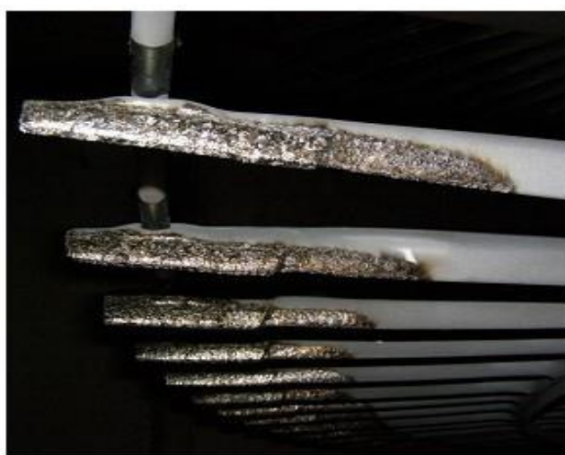
Slika 10. - Izgled novih lopatica nakon preventivne zaštite
