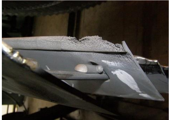
Slika 5.-Oštećene ulazne ivice i stelitne pločice
