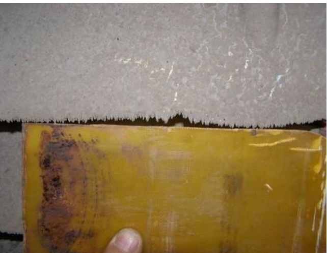
Slika 9.-Oštećena lopatica rotora Alstom
